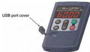
Nachdem der Umrichter über USB-Kabel an einen PC angeschlossen wurde, ist die Fernbedienung über FRENIC Loader möglich. Über einen PC mit FRENIC Loader Software können die Parameterdaten in Echtzeit bearbeitet, überprüft, verwaltet und überwacht, der Umrichter gestartet oder gestoppt sowie der Betriebs- oder Alarmstatus des Umrichters kontrolliert werden.
