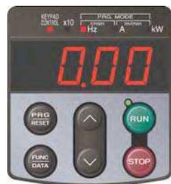
Abb. 5.2 Anzeige des LED-Monitors nach dem Einschalten
