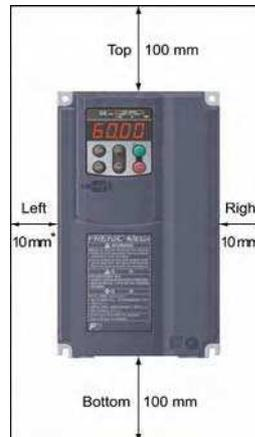
\* Halten Sie bei Umrichtern mit einer Leistung von 1,5 kW oder weniger sowie mit 30 kW oder mehr links und rechts einen Abstand von 50 mm und , 100 mm von vorn ein.
