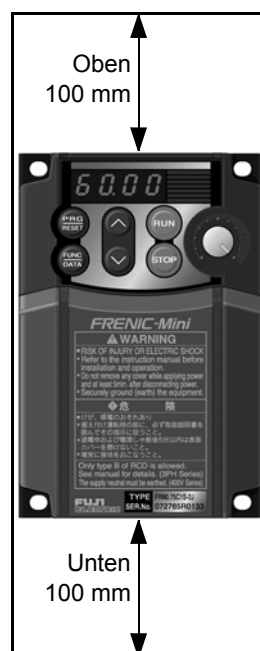
Bild 2-2-1 Montagerichtung und erforderliche Abstände
