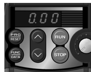
Bild 4-1-2 LED-Anzeige nach dem Einschalten
